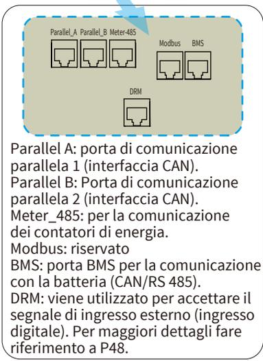
Parallel A: porta di comunicazione parallela 1 (interfaccia CAN).
